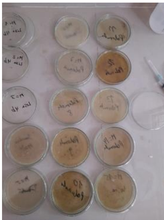
Foto 7. Saponificación con solución de KOH durante 24 horas para eliminar materia orgánica
